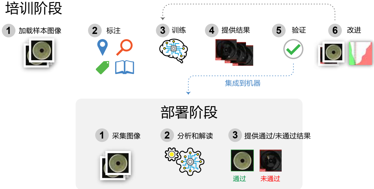
图7. 康耐视ViDi套件使技术人员能够基于一个较小的样本图像集合在数分钟内完成基于深度学习模型的训练。当应用配置完毕之后，ViDi套件可以快速提供准确的结果，并保存图像用于流程控制。
